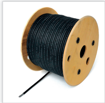
Thermoval, Przewód samoregulujący ELSR. Moc [W/mb]: 10, 15, 20, 25, 30, 40, 50. Zastosowanie: ogrzewanie nawierzchni, rynien, rur spustowych, dachów, instalacji rurowych. Gr.: od 12,80/4,60 do 17,20/9,50 mm. Moc całkowita [W]: 10-5000. Zasilanie: ~ 230 V – jednostronne.
