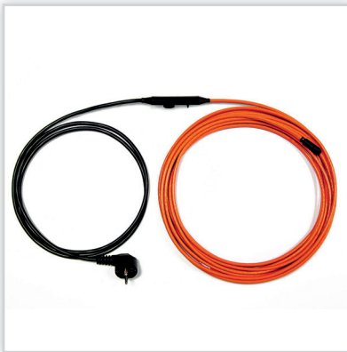
Thermoval, Przewód grzejny TV Thermo switch – stałooporowy. Moc [W/mb]: 17. Zastosowanie: ogrzewanie instalacji rurowych. Dł.: 2-49 mb. Gr.: 7,0 mm. Moc całkowita [W]: 34-833. Zasilanie: ~ 230 V – jednostronne. Dł. przewodów zasilających: 2 mb, wyposażone w wtyczkę, wbudowany bimetaliczny wyłącznik/wyłącznik.
