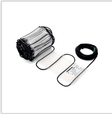
Thermoval, Mata grzejna TV AFS. Moc [W/m 2 ]: 300. Zastosowanie: ogrzewanie nawierzchni schodów. Pow.: 1,2-3,6 m 2 . Dł.: 4-12 mb. Szer.: 0,3 m. Gr.: 4,8 mm. Moc całkowita [W]: 360-1080. Zasilanie: ~ 230 V – jednostronne. Dł. przewodów zasilających: 4 mb.
