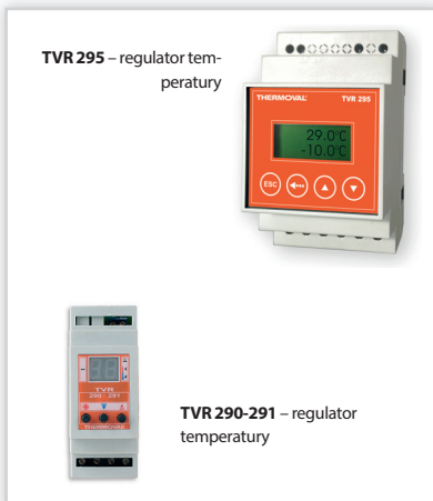
Thermoval, TVR 290-291/TVR 295 – manualny/programowalny regulator temperatury. Wbudowany programator i wyłącznik – 2 przełączniki współpracuje z 2 czujnikami, przełącznik 2x16 A (3600 W). Regulacja temp.: od -29 do +60°C (TVR 290-291), od -29 do +90° (TVR 295). Stopień ochrony: IP 20. Zasilanie [V]: 230. Montaż: szynie DIN. Zastosowanie: sterowanie (jednostrefowe – TVR 290-291; dwustrefowe – TVR 295) systemami ogrzewania, które są instalowane w podłożu, w rynnach, na dachach, rurach.
