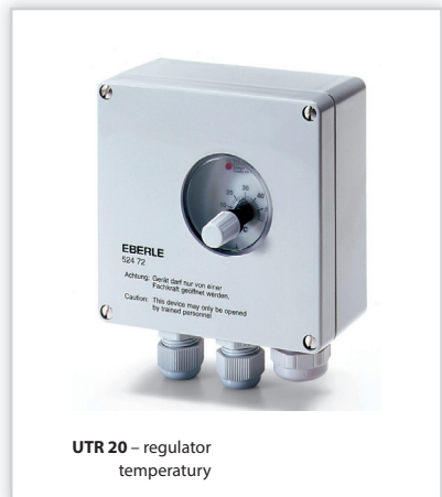
Thermoval, UTR 20 – manualny regulator temperatury. Możliwość podłączenia zegara – przełącznik 16 A (3600 W). Stopień ochrony: IP 65. Regulacja temperatury w zakresie: od -20 do +35°C. Zasilanie [V]: 230. Montaż: natynkowy, możliwość instalacji na zewnątrz pomieszczeń. Zastosowanie: sterowanie systemami ogrzewania, które są instalowane w nawierzchniach gruntowych, w rynnach, na dachach, rurach.
