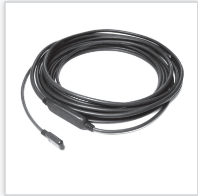
Thermoval, Przewód grzejny TV SHTL – stałooporowy. Moc [W/mb]: 20 i 30. Zastosowanie: ogrzewanie rynien, rur spustowych, dachów, nawierzchni. Dł.: 6-175 mb. Gr.: 7,0 mm. Moc całkowita [W]: 150-4800. Zasilanie: ~ 230 V – jednostronne. Dł. przewodów zasilających: 4 mb.
