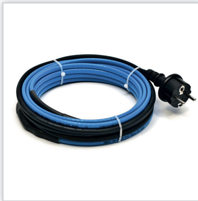
Thermoval, Przewód grzejny TVS 10 – samoregulujący. Moc [W/mb]: 10. Zastosowanie: ogrzewanie instalacji rurowych. dł.: 2-35 mb, gr.: 7,0 mm, moc całkowita 20 - 350 W. Zasilanie: ~ 230 V – jednostronne. Dł. przewodów zasilających: 2 mb, wyposażone w wtyczkę.
