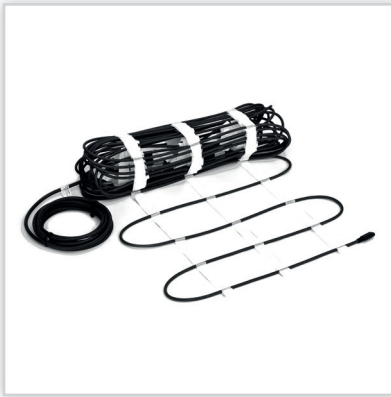
Thermoval, Mata grzejna TV HMO. Moc [W/m 2 ]: 300. Zastosowanie: ogrzewanie nawierzchni. Pow.: 1-16 m 2 . Dł.: 2-32 mb. Szer.: 0,5 m. Gr.: 6,1 mm. Moc całkowita [W]: 300-4800. Zasilanie: ~ 230 V – jednostronne. Dł. przewodów zasilających: 4 mb.
