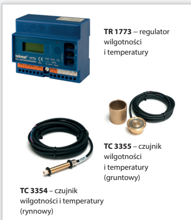
Thermoval, TR 1773 – programowalny regulator temperatury i wilgotności. Współpracuje z hybrydowymi czujnikami TC 3354 i TC 3355, przełącznik 16 A (3600 W). Stopień ochrony: IP 20. Zasilanie [V]: 230. Montaż: na szynie DIN. Zastosowanie: sterowanie systemami ogrzewania, które są instalowane w nawierzchniach gruntowych, w rynnach, na dachach, rurach.
